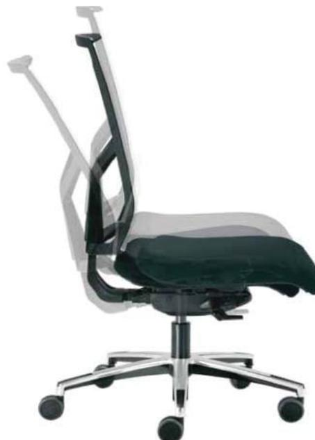
Il sedile (h 5 cm) ha una imbottitura ignifuga in CL1 (densità 40 kg/m3). È composto da due strati: uno superiore (h 2 cm) e uno inferiore (h 3 cm) che è microforato con fori da 6 mm, ciò permette alla gomma di adattarsi meglio alle sinuosità della postura e quindi conferire un ottimo confort alla seduta.
