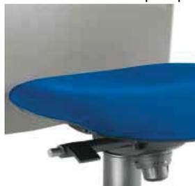
Regolazione in altezza dello schienale con sistema a cremagliera Up&Down (60 mm di corsa per 12 posizioni).
